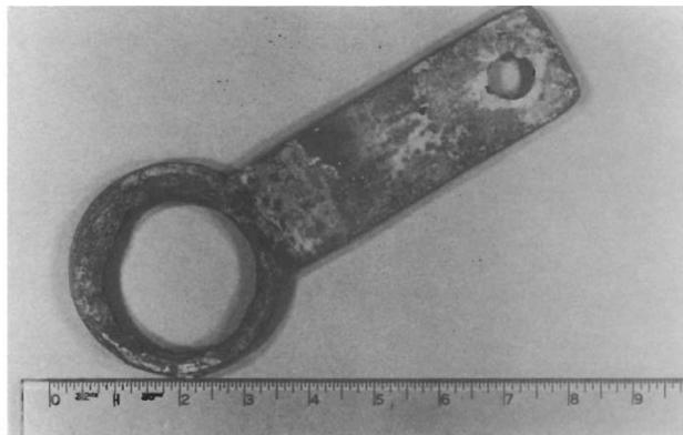
شکل 4-1: صفحه‌ی لغزنده‌ای که تا چندین ماه در محل باقی مانده بود دقیقاً از میان دچار خوردگی گردید.
