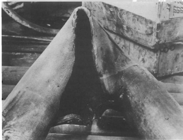
شکل 10-9: یک لوله‌ی قدیمی مجدداً مورد استفاده قرار گرفته و بر اثر خزش آسیب دید.
