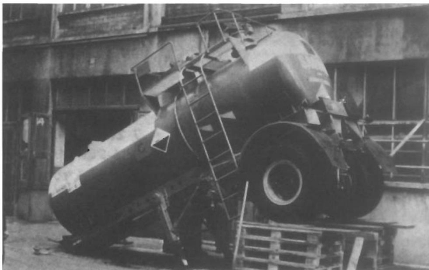
شکل 1-13: در صورت نخست تخلیه شدن مخزن پشتی ممکن است تریلر سرازیر (کج) شود.
